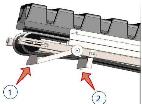
**A / EL RASCADOR 1 DEBE LIMPIARSE TAN PRONTO COMO SE DESPLACE LA PILA DE LA ZONA A**
