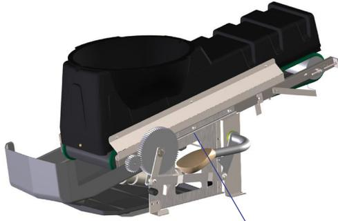
Limpie y vuelva a montar la bandeja deslizando por las barras de la cinta
