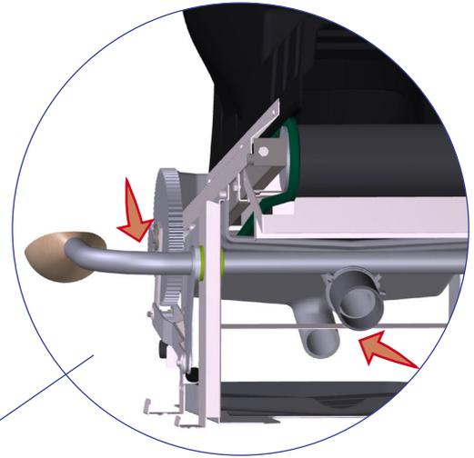
La bandeja debe colocarse sobre el eje del pedal y debe utilizar la mano para que la salida superior de la bandeja entre en el tubo de rebose
