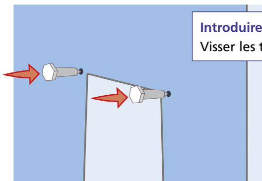
**Introduire** les tirefonds (6x40) sur les marques faites au crayon. Visser les tirefonds pour que le siège entre et sorte sans forcer.
