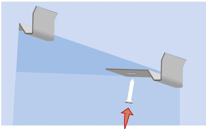
**Visser** les pattes en utilisant la lumière pour régler la position. Le siège doit entrer et sortir des pattes sans forcer.
