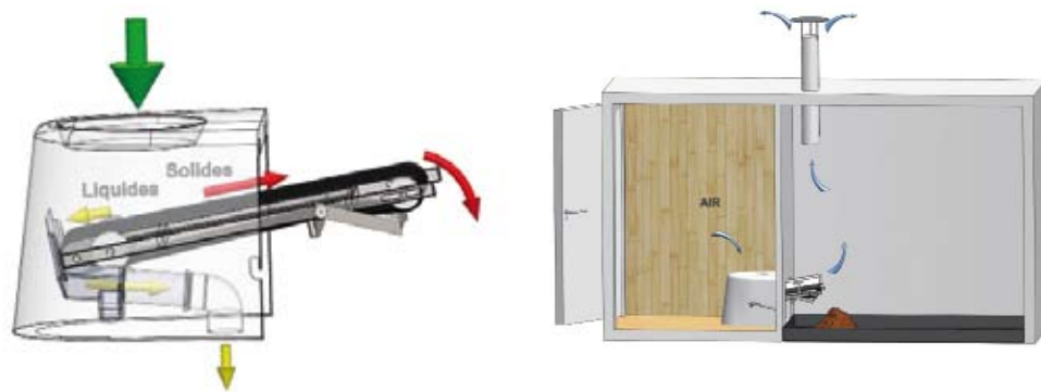
Les toilettes à séparation des urines par gravitation Ecodomeo – à l'aide d'un tapis roulant – sont destinées aux réalisations privées et fonctionnent sur le même principe que les Saniverte® d'Écosphère Technologies.
